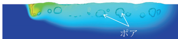
図13 EBM (a) と SLM (b) のキーホール形メルトプールの移動 (右から左)。SLMではポア (欠陥) が多数形成される (Online version in color.)
