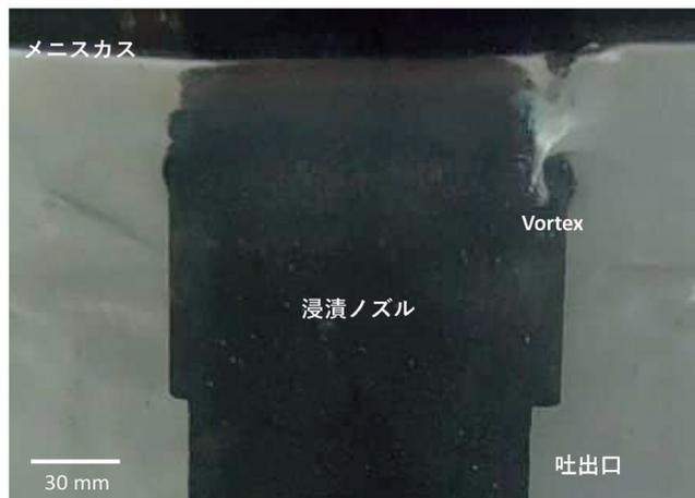
図9 水モデルにて浸漬ノズル近傍に生じたVortexの例 (Online version in color.)
