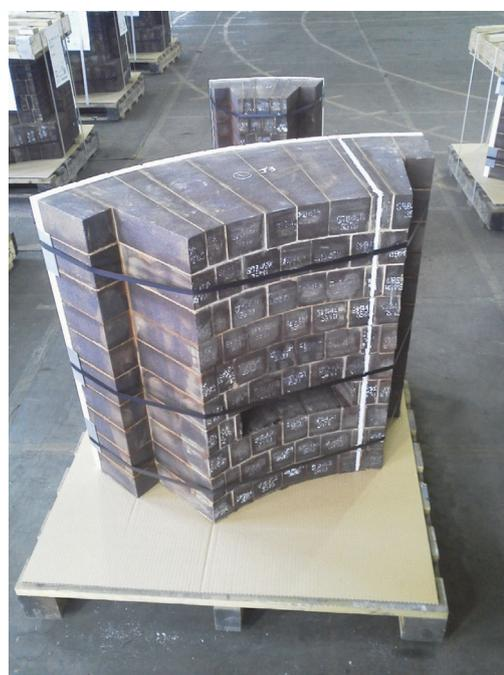
図6 RH脱ガス装置・上部槽ブロック施工に用いられるブロックの例 (Online version in color.)
