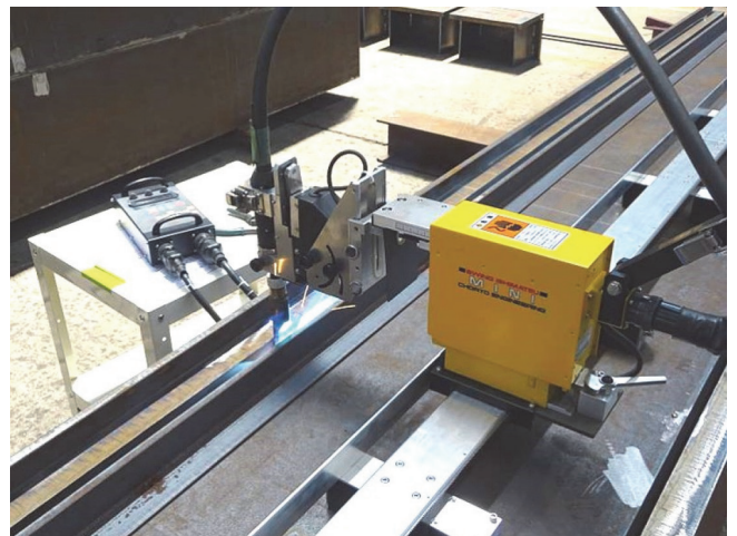
図8 開発技術適用状況 (四面ボックス柱の角溶接) (Online version in color.)
