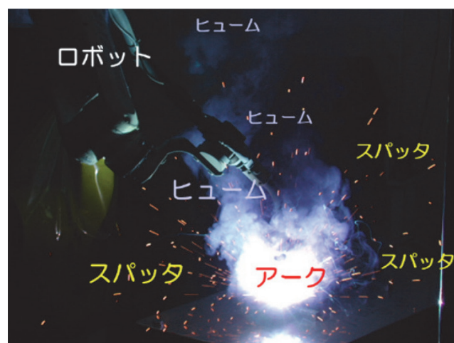
図4 炭酸ガスアーク溶接で発生するスパッタ (Online version in color.)
