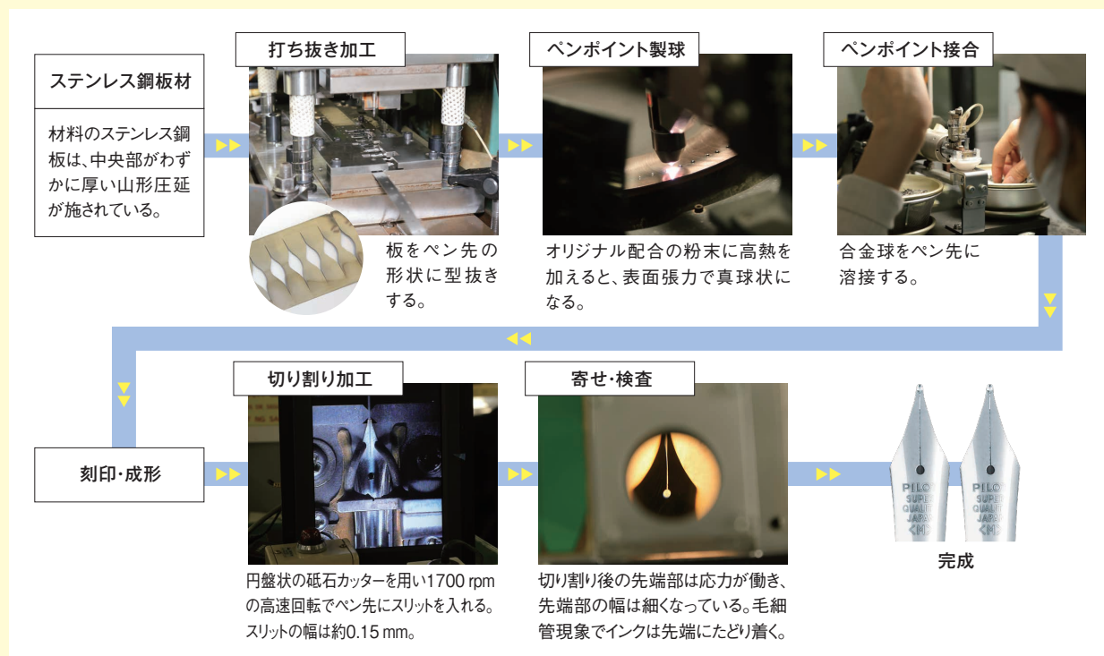
図5 鉄ペンの製造工程
