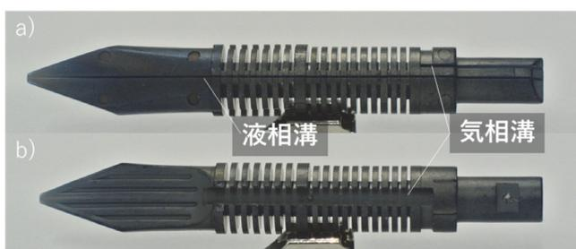
図7 ペン芯の写真(Pilot カクノ) a) 上側, b) 下側 (Online version in color.)
