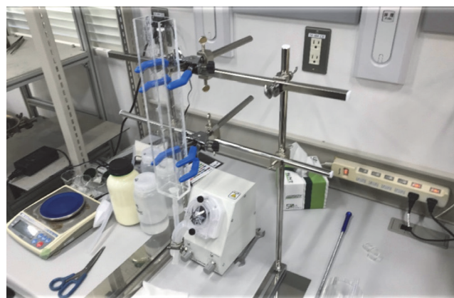
図1 気液混相流体用の実験装置（自作）（Online version in color.）
