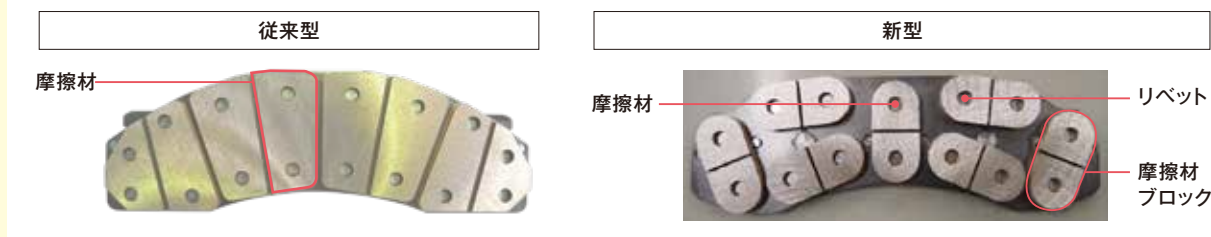
図5 ブレーキの摩擦材の改良
