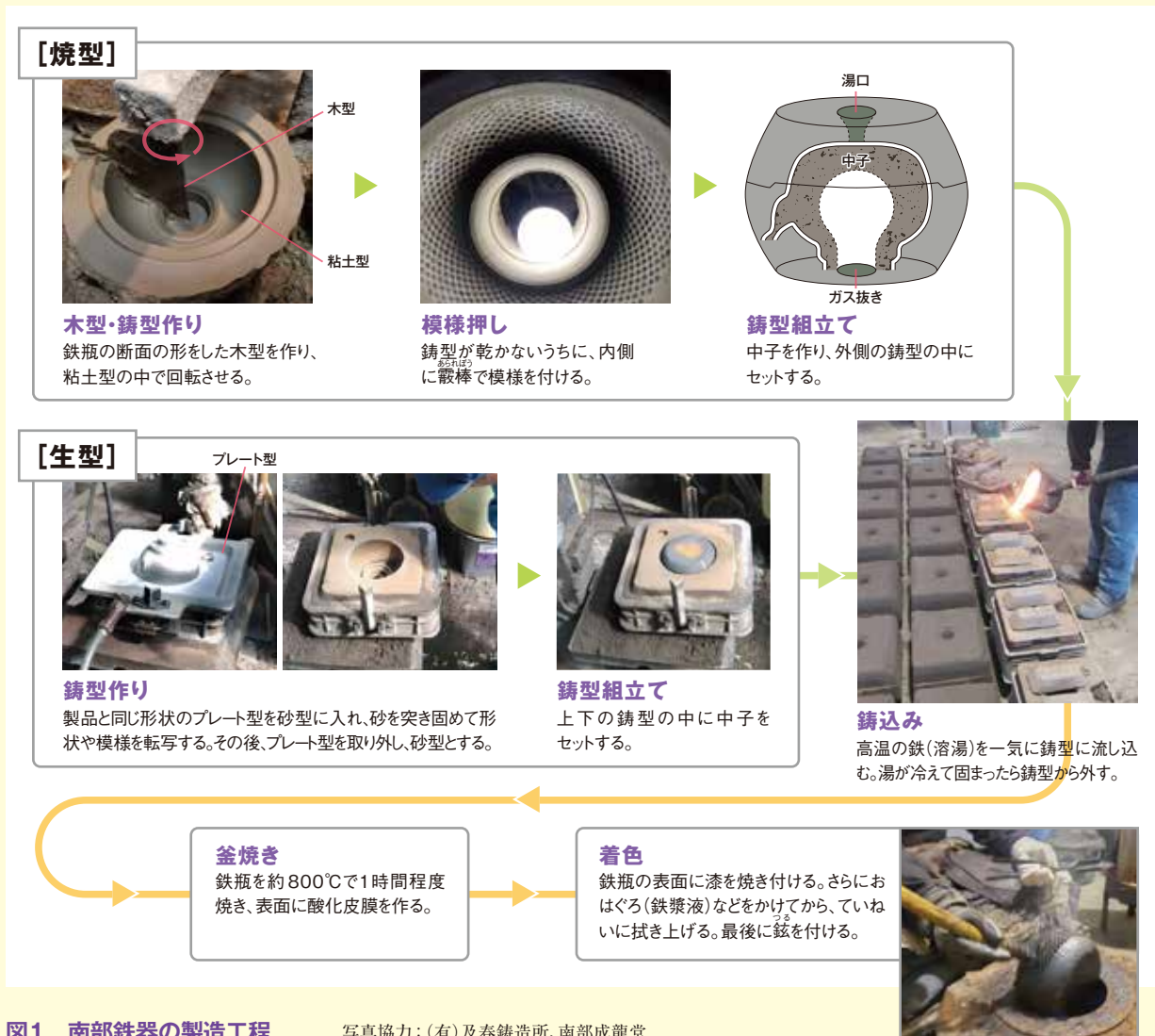
図1 南部鉄器の製造工程
