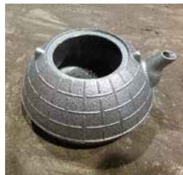
3Dデータを元に鑄造された試作品
