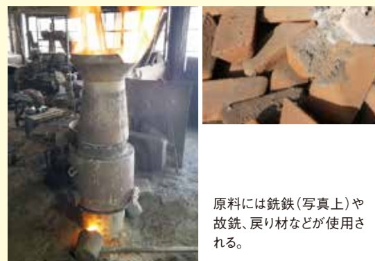
図2 原料の溶解に使用される「こしき炉」
