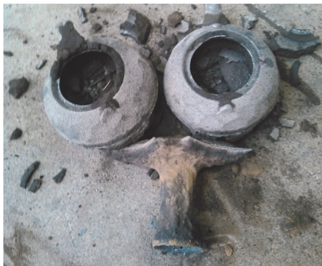
図12 型バラし後の試作品（本体）（Online version in color.）
