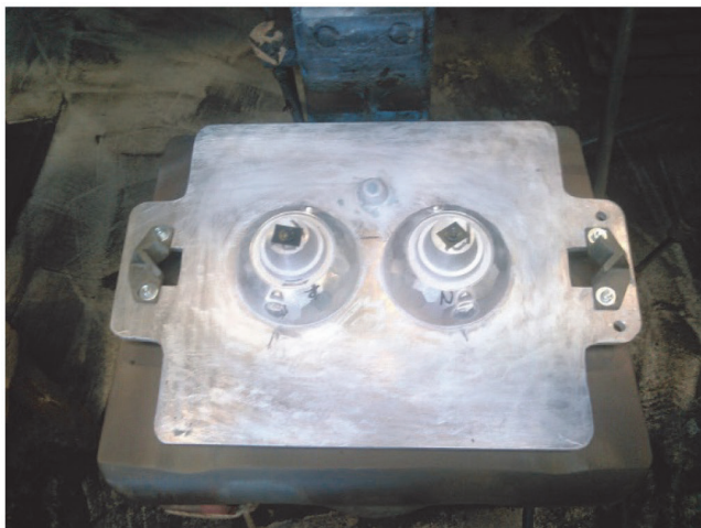
図11 湯口を加えたマッチプレート金型（本体）（Online version in color.）
