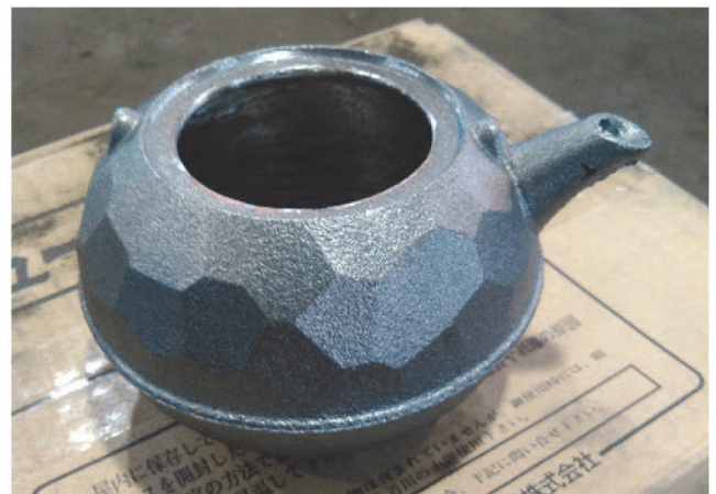
図13 砂落とし及び加工後の試作品（Online version in color.）
