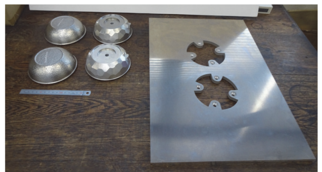
図10 本体マッチプレート金型の構成 (Online version in color.)
