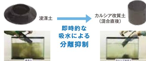
浚渫土とカルシア改質材の混合直後に、カルシア改質材の吸水作用により粘性が増大する。このため、カルシア改質土は、混合直後の水中投入時に、浚渫土単体よりも濁りの発生を抑制することができる。
