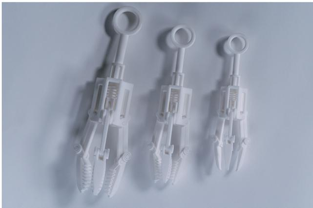
図11 Scalable Hands, 3Dプリンタにより一体成形で制作されたロボットハンド、設計変更なくCADデータの単純な拡大縮小によって80%から120%の範囲で無段階のサイズ展開が可能 (Online version in color.)
