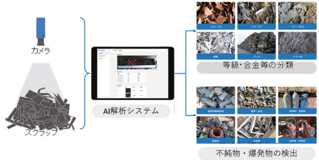
図8 AI画像認識によるスクラップ分別システムの概念図 (Online version in color.)
