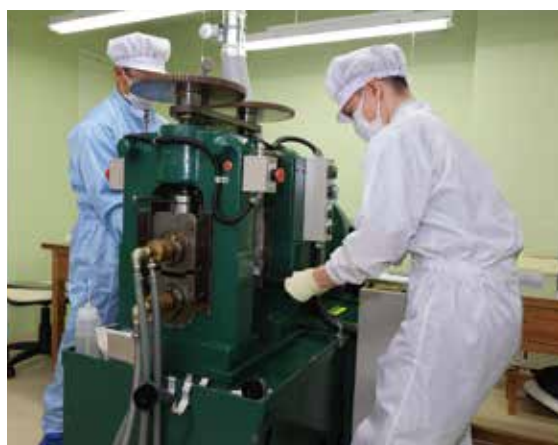
冷間圧延機では入れ手と受け手が息を合わせてロール間に材料を通す。
