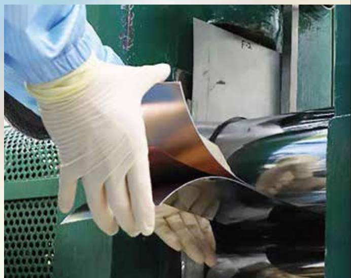
冷間圧延後のステンレス鋼箔を丁寧に引き出す。
