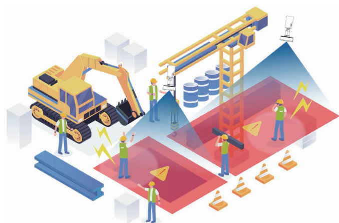
図6 ディープラーニングによる画像認識技術を利用した安全AIシステム
