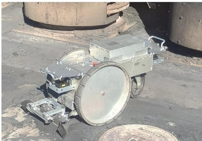
図9 難条件対応型自走式清掃ロボット (Online version in color.)
