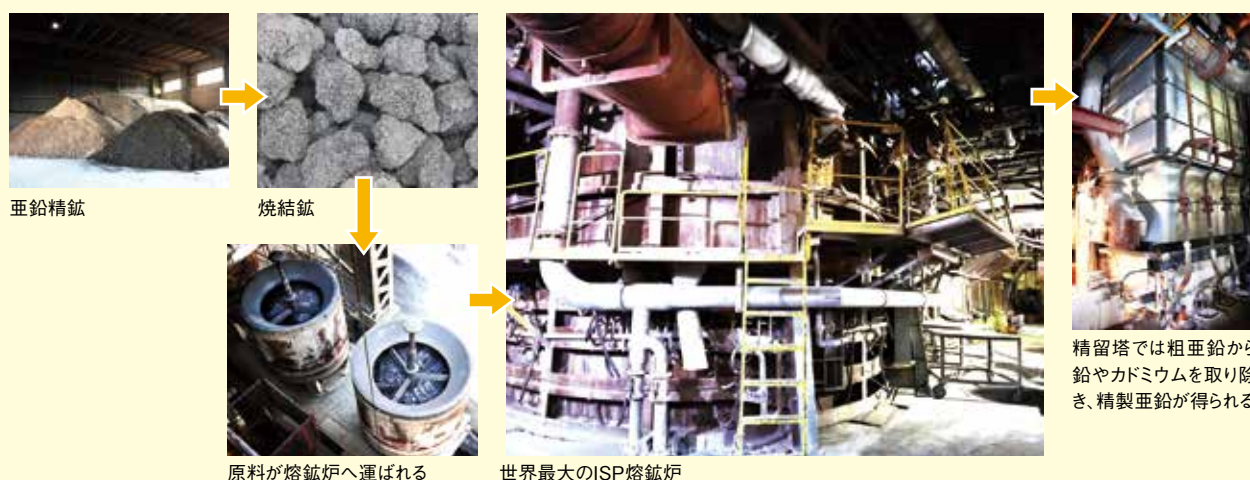
図2 亜鉛製造の主な設備
