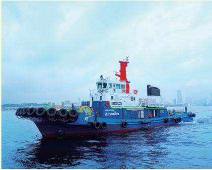
図4 アンモニア燃料タグボート「魁」
