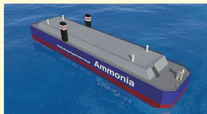
図7 浮体式アンモニア貯蔵再ガス化設備搭載バージ(A-FSRB<sup>注</sup>)(想像図)
