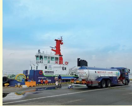
図5 アンモニア燃料補給の様子
