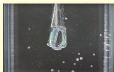
図5 特殊溶液中での酸化皮膜生成
