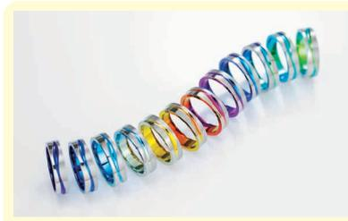
図6 酸化皮膜の厚さによって変化する色のサンプル
