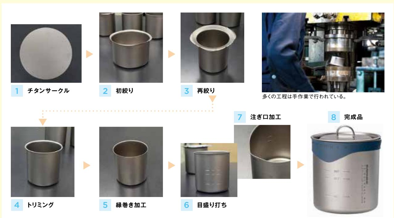
必要な大きさに打ち抜かれたチタン板(チタンサークル)を「シワ押さえ板」で押さえながら、外周部を中心に引き込むような形でダイ(金型)の穴に押し込み、円筒を成形していく。1度の加工で目的の深さが得られ無い場合には複数回に分けて加工する。金型の形状や潤滑剤は重要なノウハウになる。周辺部は余分な材料を除去した後、端部を丸める「縁巻き加工」が施される。目盛りや注ぎ口を形成した後、脱脂・洗浄が行われ、完成品になる。
