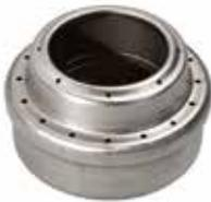
直径 71 mm、高さ 42 mm、質量 34 g で 30 mL のアルコールで約 5 分間燃焼し、およそ 400 mL のお湯を沸かすことができる。
