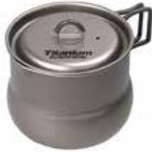
側面を膨らませることで、注ぐ湯量がコントロールしやすくなっている。直径 124 mm、深さ 95 mm、肉厚 0.4 mm、容量 800 mL、質量 130 g。
