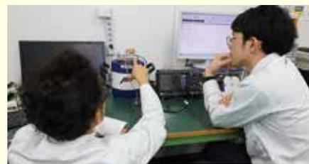
振動発電特性の評価試験
