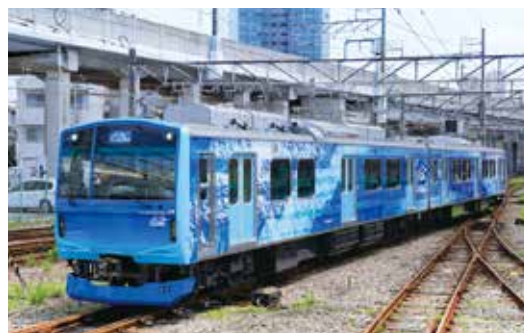
鶴見線で実証試験中の燃料電池ハイブリッド車FV-E991系。愛称は「HYBARI (HYdrogen-HYBrid Advanced Rail vehicle for Innovation)」。
