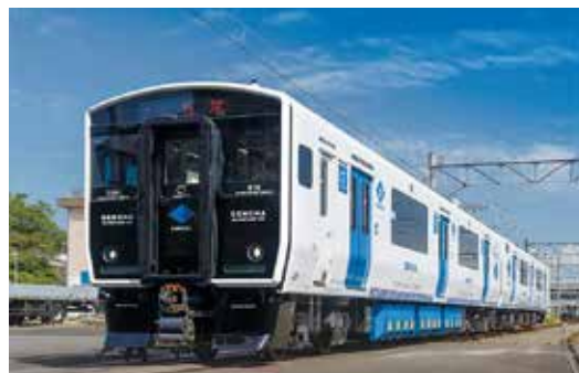
2016年より若松線で運用されている架線-蓄電池ハイブリッド車 BEC819系。愛称は「DENCHA (Dual ENergy CHArge train)」。 車両下部の青い部分にリチウムイオン電池が収納されている。
